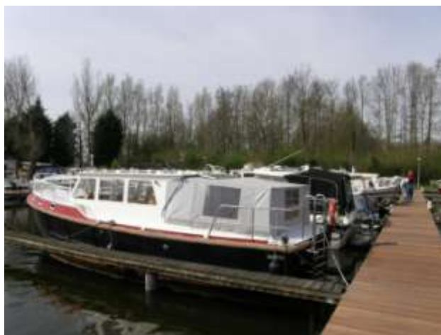
Motorboot 'Barkas', L x B x d = 10 x 3,20 x 0,80 m. Hoogte opbouw: 2,40 m.
